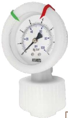
為一體化設計，具備壓力錶與隔膜功能。採用全PVDF外殼材質，適用低腐蝕性、低結晶性及低黏稠性等介質的壓力量測。
