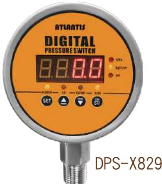
集壓力測量、顯示、控制於一體的智能型數位壓力開關，可設置兩路常開常閉警報，也可實現兩路高低壓控制。
