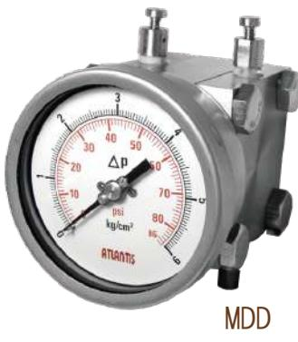
主要用於過濾器的正負壓力端，液體灌液位、泵出入口、輸油管線、輸氣管線和加壓泵站等場合的壓差測量，耐壓高，可測量腐蝕性介質，可搭配三通分岐閥。
