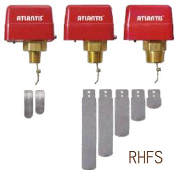
採用SPDT微動開關控制，應用在水、乙二醇或其他未劃分之危險液體管線上。當液體流量超出或低於設定流量時，藉由底部不鏽鋼流向片給予設備供電或斷電。
